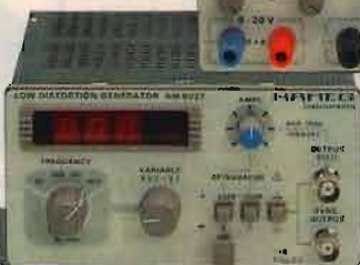
HM 8037. Generatore a bassa distorsione 5 Hz - 50 KHz Letture digitali della frequenza
